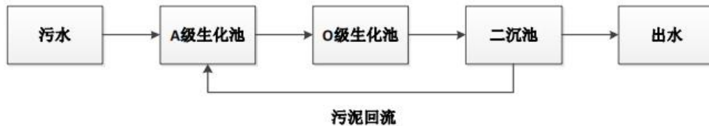
图 4-1 一体化污水处理设备工艺流程图
